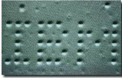
Bild 4 : Das RTM als Werkzeug in kleinsten Dimensionen: Mit Hilfe der Mikroskop- Spritze gelang es, den Schriftzug "IBM" aus einzelnen Xenon-Atomen zu "schreiben".
