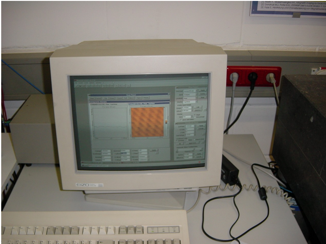
Bild 6 : Darstellung atomarer Strukturen von Graphit mit dem Easy-STM
